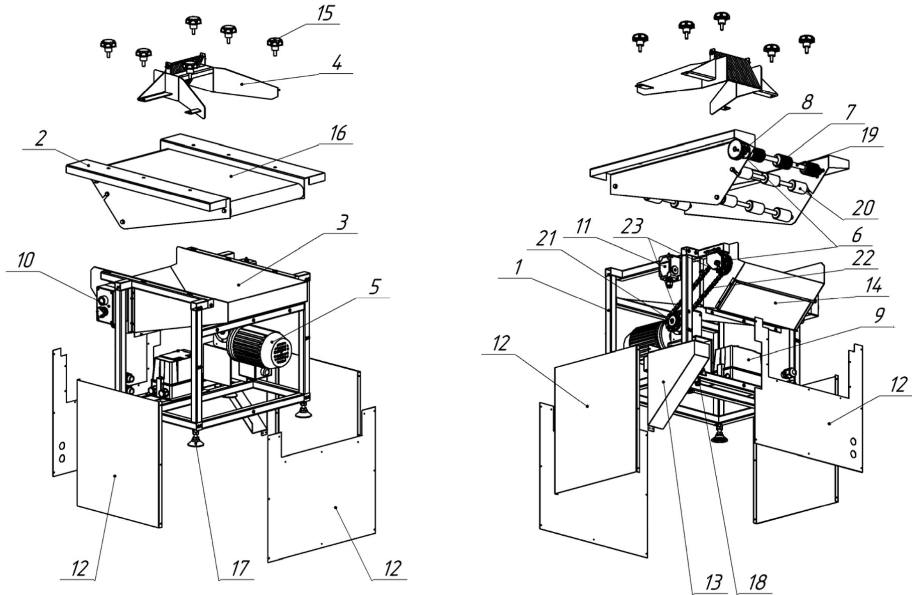
Рисунок 1, б. Машина для нанесения панировки ИПКС-130П(Н)
