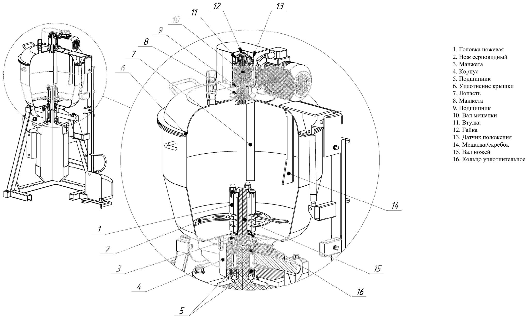
Рисунок 3. Куттер ИПКС-032-80(Н); ИПКС-032-80Р(Н); ИПКС-032-80П(Н); ИПКС-032-80РП(Н). Внутреннее устройство
