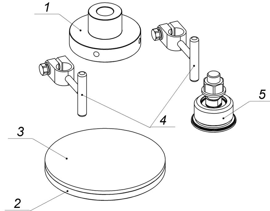
Рисунок 4. Состав комплектов ИПКС-127УЗ-10, ИПКС-127УЗ-11
